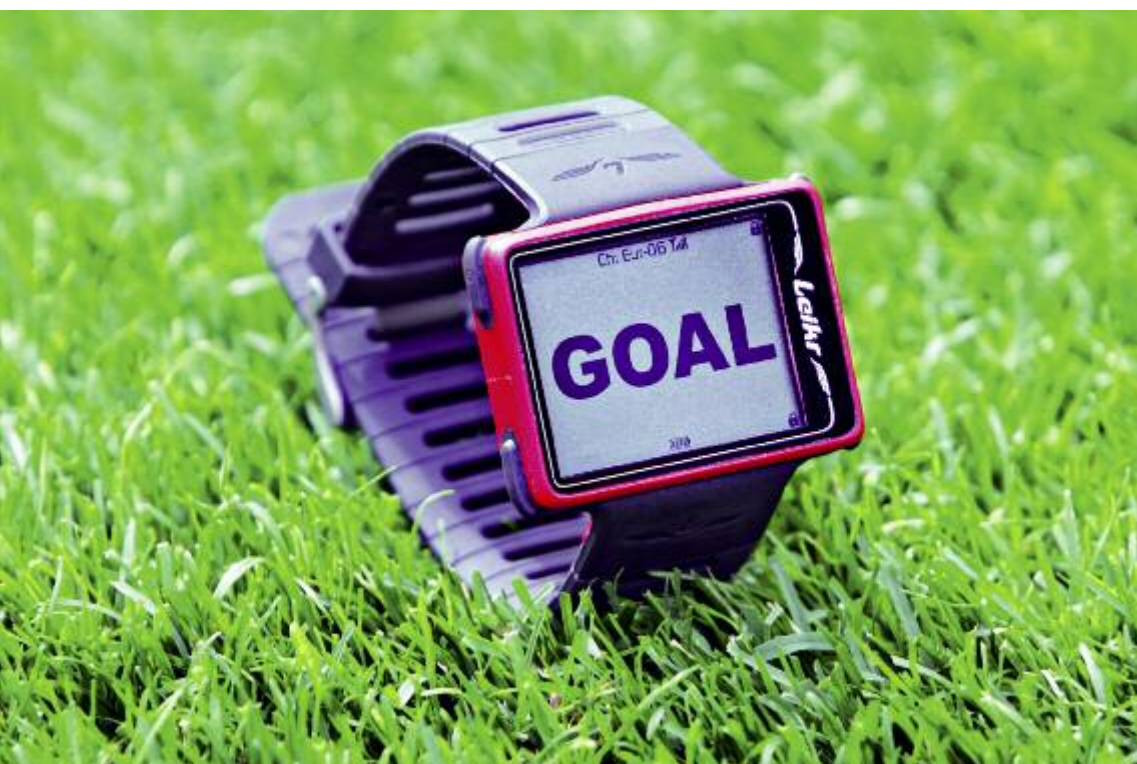
Innovation in der Bundesliga: Die Anzeige auf der Armbanduhr zeigt dem Schiedsrichter an, dass der Ball die Torlinie überschritten hat.
