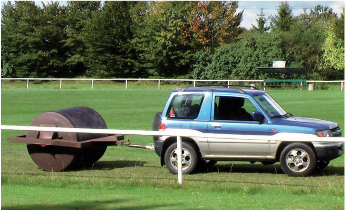
Abb. 82: Walzenart und „Zugmaschine“ sind auf Tenne und Rasen nicht zu verwenden.
