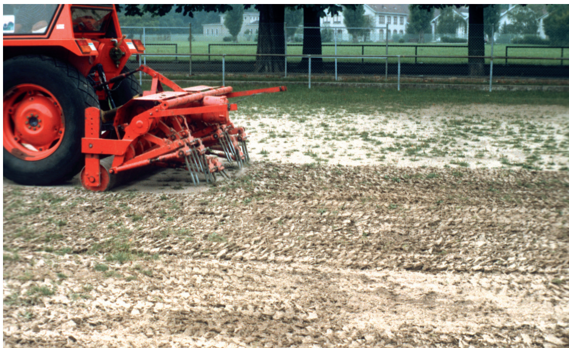
Abb. 56: Brechen oberflächennaher Verdichtung mit meielartigen Werkzeugen (Voraussetzung: trockener Boden whrend der Bearbeitung)
