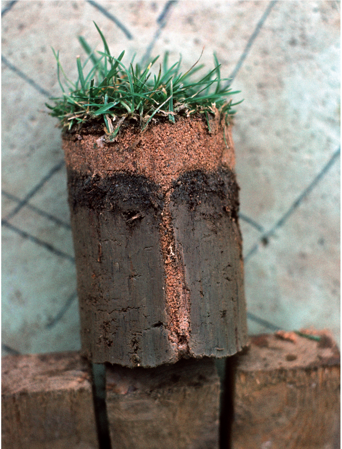
Abb. 58: Sandverfüllte Schlitzte mit zu dicker Auflage eines zu groben Sandes auf einer in Zersetzung befindlichen Filschicht. Die zu starke Sandschicht verleiht den durchwurzelnden Gräsern keine Scherfestigkeit.
