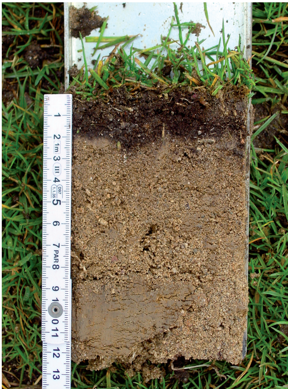
Abb. 39: Starke Rasenfzlbildung von 20 bis 25 mm Dicke auf einer Rasentragschicht; wenig benutzte und wenig bis nicht vertikutierte Sportfläche
