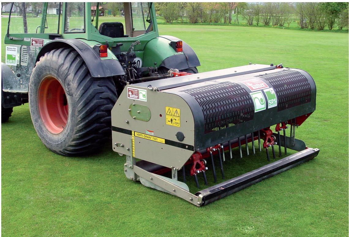
Abb. 43: Löchern (oder Tiefenlockerung) mit dem Vertidrän (Löchern ggf. bei Rasentragschichten und Sandböden mit Hohlspoons; Tiefenlockerung mit Vollspoons)
