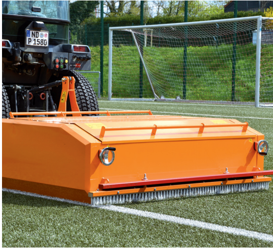
Abb. 124: Pflegegerät für Intensivreinigung
