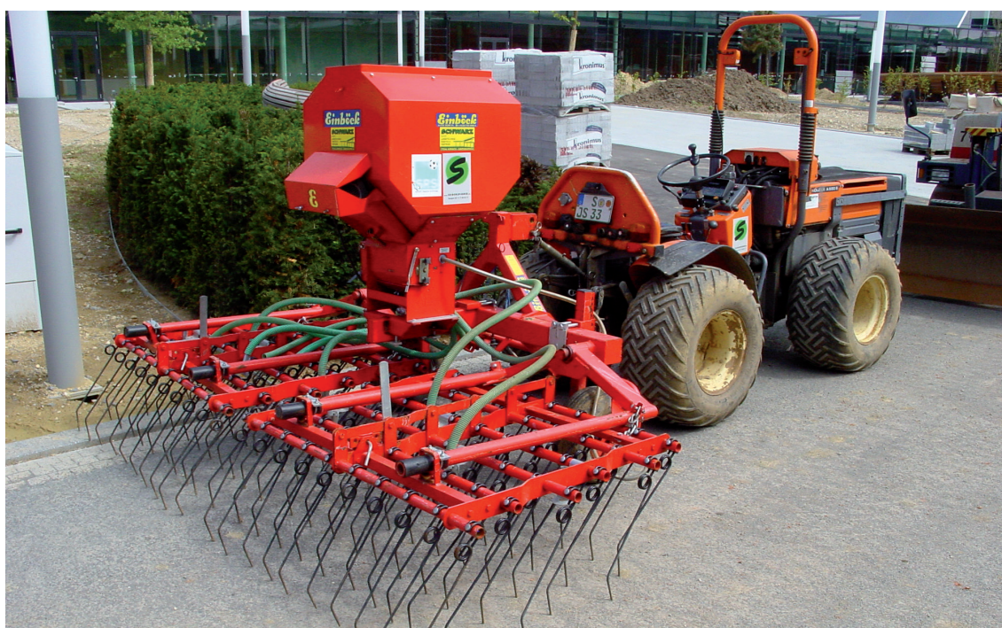
Abb. 41: Arbeitswerkzeuge eines Rasenstriegels zur vielfältigen Anwendung; hier mit Nachsaatvorrichtung
