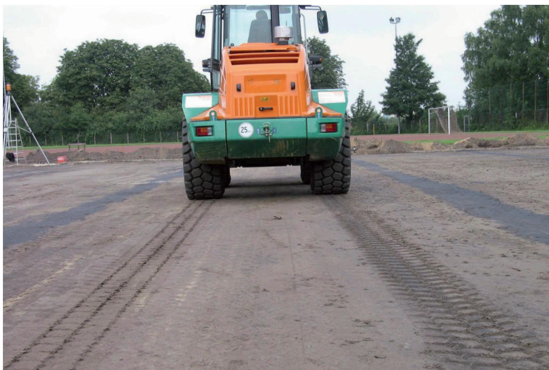
Abb. 73: Befahrungsversuch, keine Verformung
