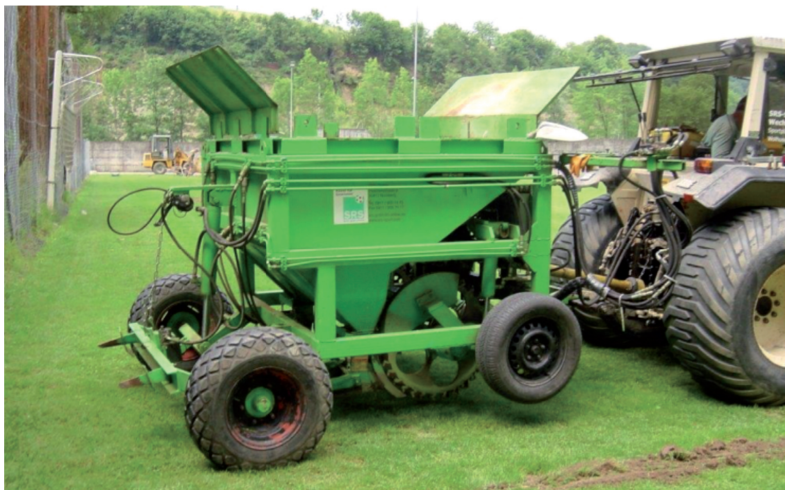
Abb. 62: Herstellen und Verfüllen schmaler linearer Sickerschlitzte
