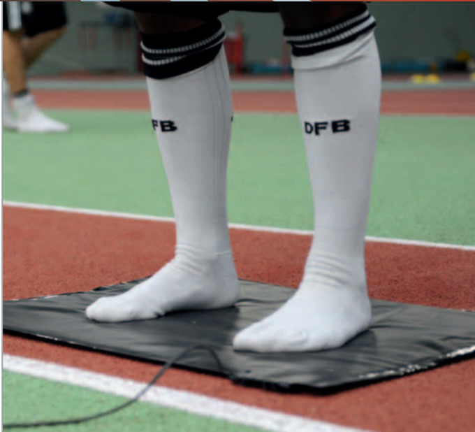
Messmatte zur Bestimmung von Bodenkontakt- und Flugzeit
